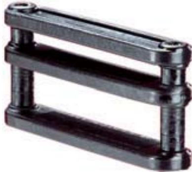
Die Hauptstromleitung wird im oberen Fenster  $s_1$  festgeklemmt, die Steuerleitung (en) mit genügend Spiel ( $> 2 \text{ mm}$ ) im unteren Fenster  $s_2$  geführt. Die Leitungsklemmen werden vom Hersteller so montiert, daß das Fenster  $s_1$  mit dem Kleinmaß, das Fenster  $s_2$  jedoch mit dem Größtmaß eingestellt geliefert wird.
